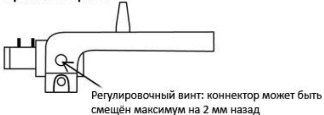
Регулировочный винт: коннектор может быть смещён максимум на 2 мм назад
